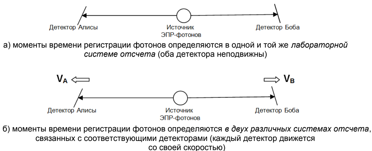
Рисунок 1. Схема определения моментов регистрации двух фотонов
